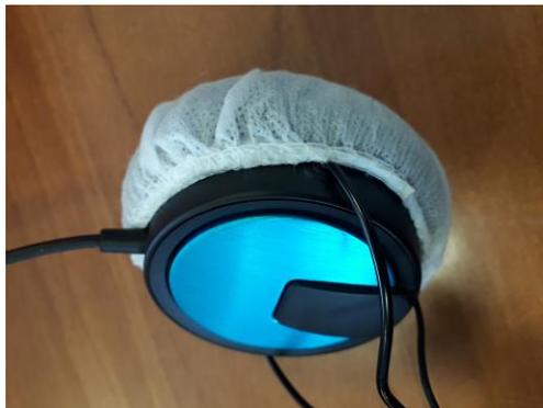
Abbildung 7 Anbringung des hygienischen Schutzhäubchens an einer Kopfhörermuschel
