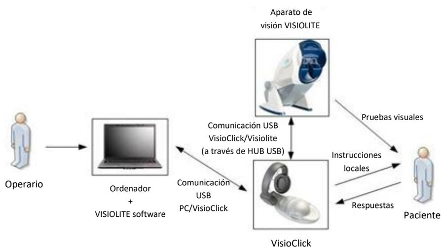
Figura 3 Esquema del modo de funcionamiento de VisioClick®
